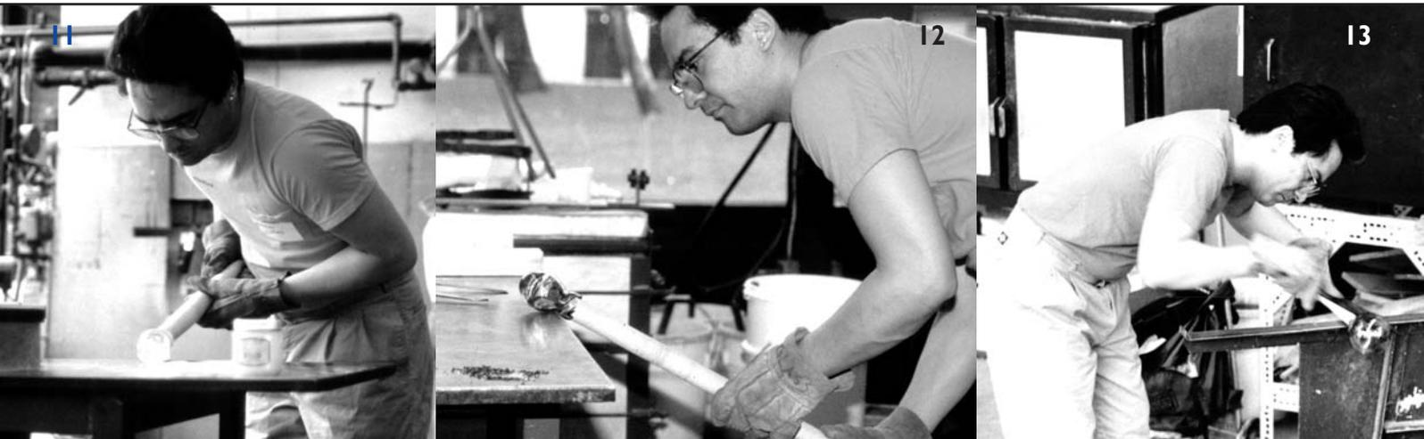
Fig. 11 — Tourner sur le marbre pour refroidir et façonner le verre ; 12 — Rouler sur la bordure du marbre pour trancher ; 13 — Limer avec une lime en métal pour affaiblir le verre.
