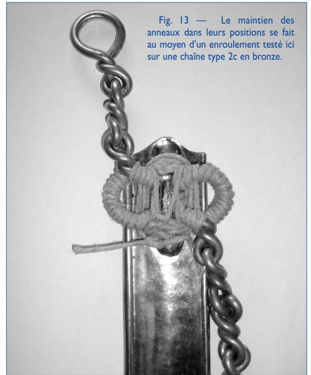
Fig. 13 — Le maintien des anneaux dans leurs positions se fait au moyen d'un enroulement testé ici sur une chaîne type 2c en bronze.
