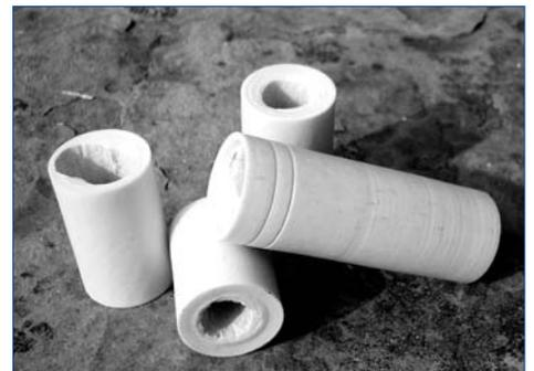
Fig. 1 — Charnons bruts de tournage, traces de la gouge bien visibles sur le plus long.
