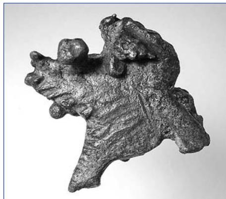
Fig. 1 — Extrémité de poignée delphiniforme victime d'un accident de coulée.
