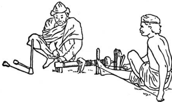
Fig. 3 — Tourneur sur bois et son aide : artisanat traditionnel de l'Inde (d'ap. Filliozat 1962, 328, fig. 42). Noter la position assise et l'utilisation du pied.
