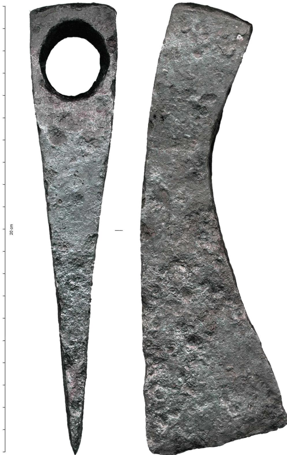
Hache à lame étroite, en forme de coin ; œil d'emmanchement pratiquement circulaire prolongé vers le haut par une plage carrée permettant éventuellement une percussion ; le tranchant est axé sur l'emmanchement et a parfois été obtenu par repli du fer autour de ce dernier, comme sur l'exemplaire de Haltern (DE) reproduit page suivante.
