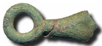
Piton soudé sur une tôle enroulée
