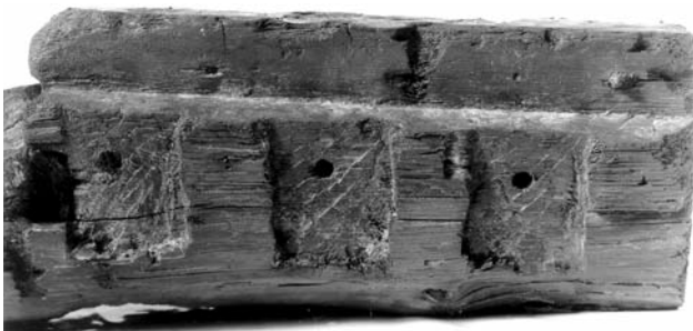
Figure 10 — Épave de la Chrétienne A . Vue latérale de la quille. Noter l'arrachement du bois de la joue de la quille le long de la ligne de mortaisage d'assemblage du galbord dans la râblure (cliché G. Réveillac, Centre Camille Julian, CNRS, Aix-en-Provence).
