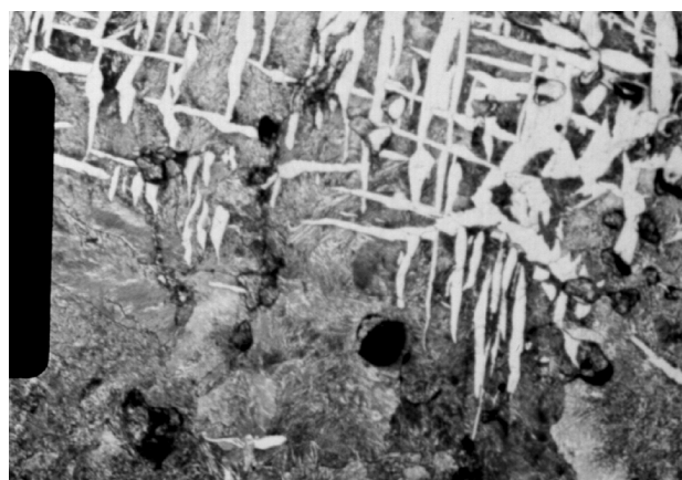
Fig. 18 — Eponge de fer du Mali, voir figure 17 (Serneels et al. 1997). Photo prise au microscope en lumière réfléchie. Le métal est principalement constitué de perlite (aspect d'agrégat vermiculaire). On observe de grands cristaux aciculaires de ferrite orientés parallèlement les uns aux autres et selon des directions particulières (proche de la texture de Widmanstätten) qui indiquent un refroidissement rapide depuis une haute température et l'absence de déformation mécanique.
