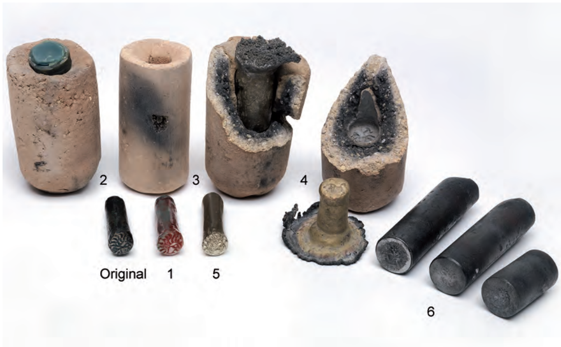
Abb. 12: Moderner Gieß- und Schmiedeversuch. Herstellung einer Bronzepatrizze nach antikem Vorbild und Abschläge auf Eisenrohlingen (= Stempel) (Foto: Archäologische Staatssammlung München, St. Friedrich).
