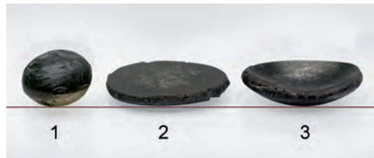
Abb. 13: Moderner Gieß- und Formversuch unter Verwendung einer Kugelanke in den verschiedenen Stadien der Bearbeitung: 1 Silberkugel, 2 planierter Silberrohling, 3 schüsselförmiges Endprodukt. M. 1,5:1 (Foto: Archäologische Staatssammlung München, St. Friedrich).
