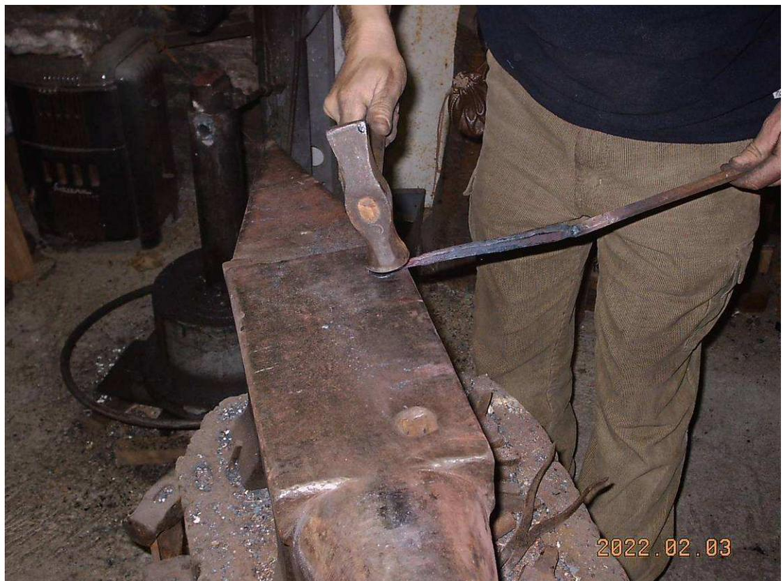
**D - Façonnage de la douille**
