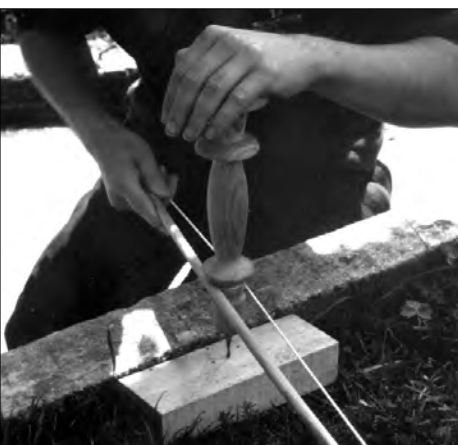
Fig. 4 — Utilisation du trépan et de l'archet.
