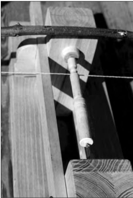
Fig. 4 — Fixation de l'ébauche et mise en mouvement de l'axe de rotation. Remarquer la longueur importante de la pointe de la poupée mobile.
